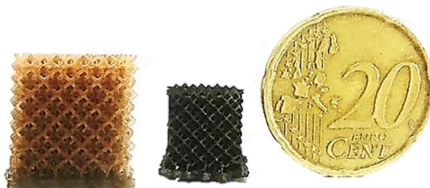
**Figure** : Structure 3D avant (à gauche) et après pyrolyse (à droite).
