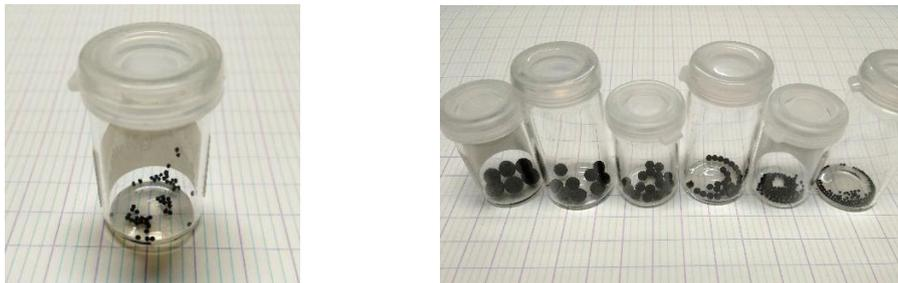
**Figure 2:** Sphères creuses de carbone : de même diamètre (0.8 – 1 mm) et de différentes conductivités (de  $3.5 \times 10^{-6}$  à  $15 \times 10^3$  S/m) d'une part (à gauche), et de différents diamètres (5, 4, 3, 2, 1 et 0.8 mm) mais de même conductivité (125 S/m) d'autre part (à droite).
